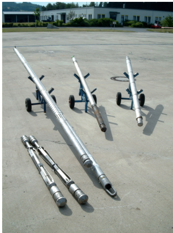
Abbildung 2-4 : Logging tools des ICDP (International Continental Drilling Programs) am GFZ-Potsdam ( www.gfz-potsdam.de ).
